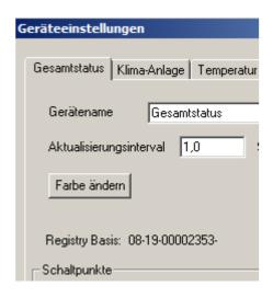
Für jedes Gerät finden sich unter den Registry-Eintrag "Cleware GmbH->USB" verschiedene Einträge. Die Einträge beginnen mit einem eindeutigen, verschlüsselten Kennzeichner. Dieser eindeutige Kennzeichner wird in ClewareControl bei Öffnen der Geräteeinstellungen für jedes Gerät als Registy-Basis angezeigt.
