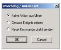
Wird "Cleware Ereignis setzen" gewählt wird ein Fehlerereignis "ClewareControl", Nummer 16 im Anwendungsprotokoll gesetzt. Die Möglichkeit "Reset Kommando .." sendet ein Kommando zum Auslösen des Wächters direkt an diesen. Beide Optionen werden erst ausgeführt, wenn die Auswahl mit dem OK-Knopf bestätigt wird.
