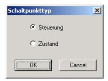
Die Geräte USB-Switch und der USB-IO16 als Ausgabe konfiguriert haben zwei verschiedene Aktionsmöglichkeiten. Die normale ist die "Steuerung" zum Einstellung einer zeitgesteuerten Aktion. Mit ClewareControl 3.1.3 gibt es zusätzlich die Möglichkeit, eine Aktion abhängig vom Zustand auszulösen. Damit ist es möglich, eine Aktion auszulösen, wenn das Gerät entfernt wird.
